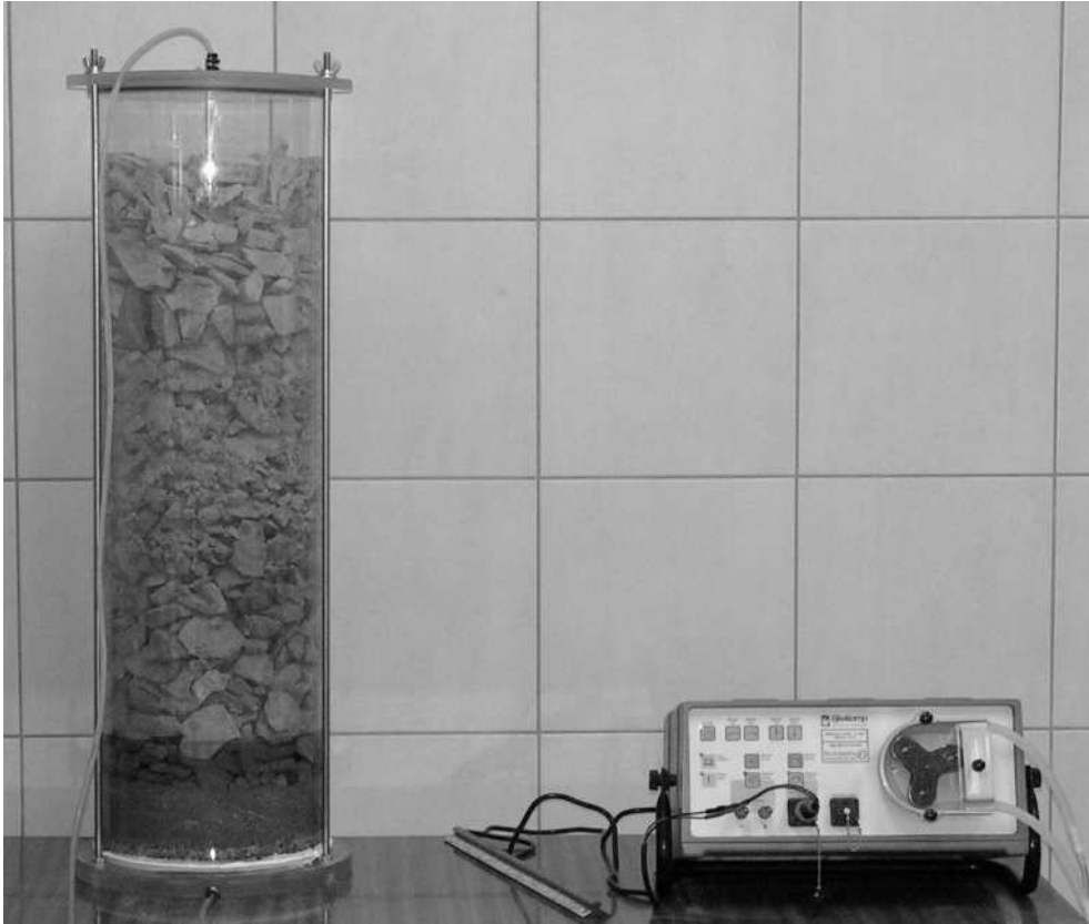
Rysunek 1. Zdjęcie instalacji badawczej wykonanej dla potrzeb dynamicznego testu wymywalności skał triasowych z kopalni „Trzebionka”
